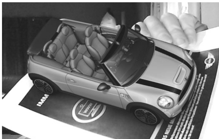
Rys. 5. Projekcja modelu samochodu na znaczniku umieszczonym na kartce papieru
