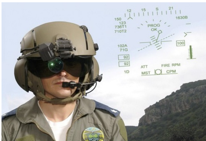
Rys. 1. Wyświetlacz HMW wykorzystywany przez pilotów
