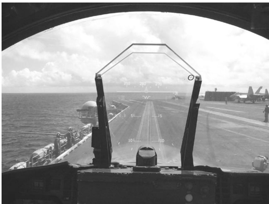
Rys. 2. HUD w samolocie F/A-18 Hornet
